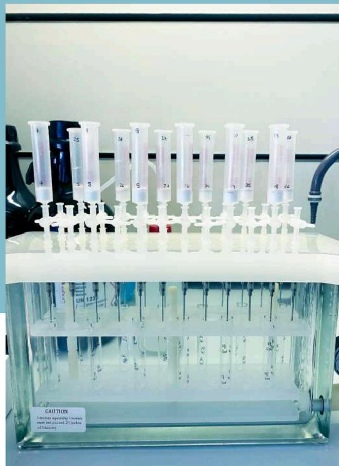
Figura 12/Purificazione e concentrazione degli "elutriati 1" e "2" attraverso cromatografia a bassa pressione con resine per estrazione in fase solida (SPE, Backerbond SPE C18, 500mg, 6mL, Gilson Aspec GX271, Gilson Inc.).
