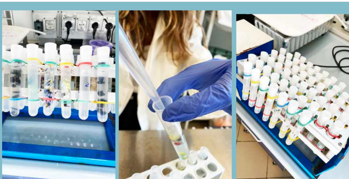
Figura 11/Preparazione dei frammenti di dimensioni < 1 cm, e fasi di lavaggio dei campioni nelle soluzioni di acqua di mare artificiale, metanolo o acido nitrico per l'ottenimento degli estratti.
